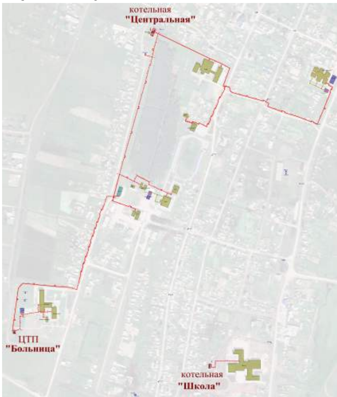
Рис. 1-1. Принципиальная схема теплоснабжения с. Баяндай
